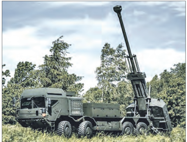
155-мм самоходная гаубица «Арчер» на шасси автомобиля RMMV HX2
