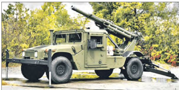
Самоходная 105-мм гаубица М20 на базе автомобиля «Хамви»
