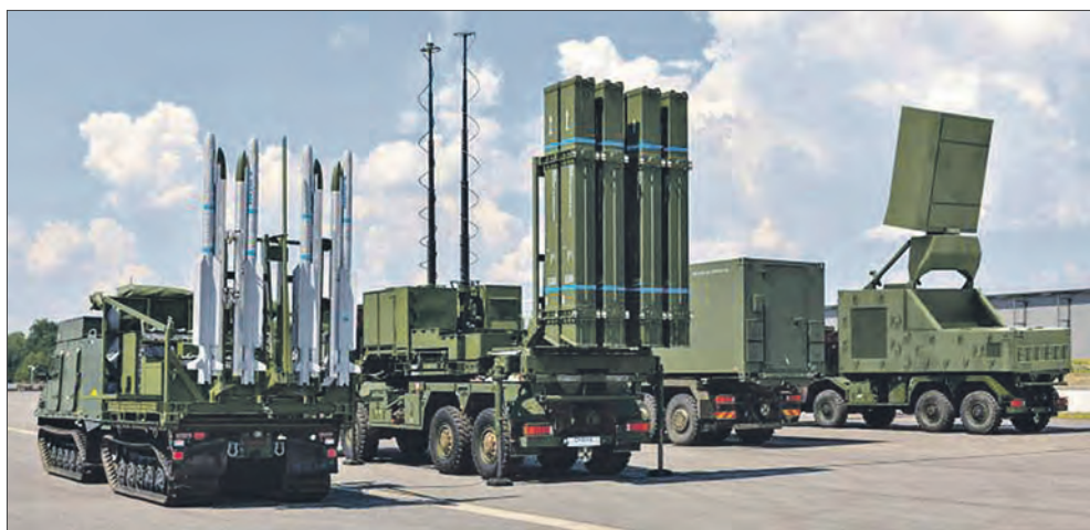
Средства ЗРК «Ирис-Т» (слева направо): пусковая установка «Ирис-Т SLS» для вооруженных сил Швеции на базе сочлененного БТР Bv 410, пусковая установка версии SLM в германской конфигурации, РЛС Saab Giraffe 4A
