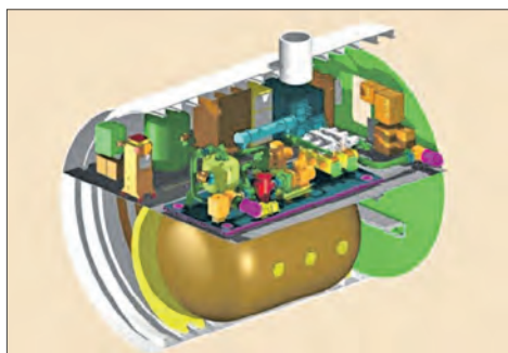
Компоновка ВНЭУ с риформингом биоэтанола фирмы «Абенгоа хинергрин» для испанской НАПЛ S-80 (2005)
