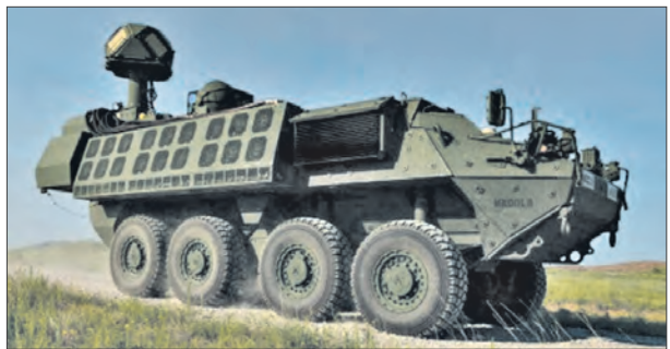
Опытный образец лазерного комплекса ПВО ближнего действия на базе БМ «Страйкер»
