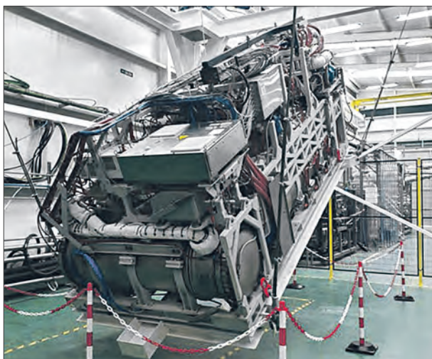
Установка риформинга биоэтанола ВНЭУ BEST в процессе испытаний
