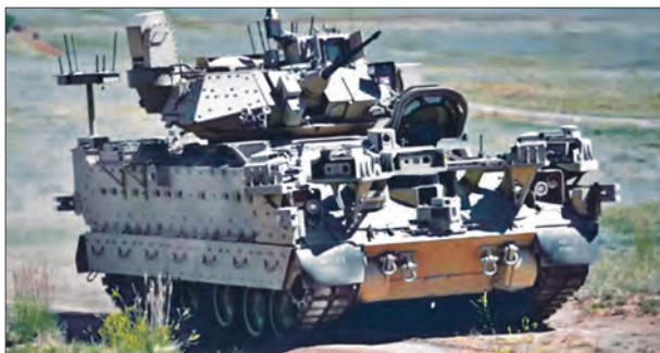
Прототип машины управления MET-D на базе БМП серии «Брэдли»
